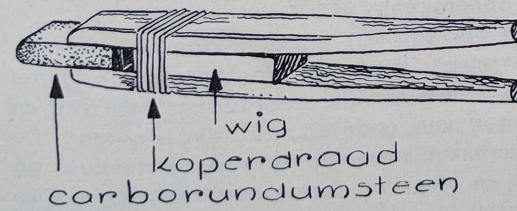
Fig. 173. Klemlatten voor het schuren van inwendige hoeken.
